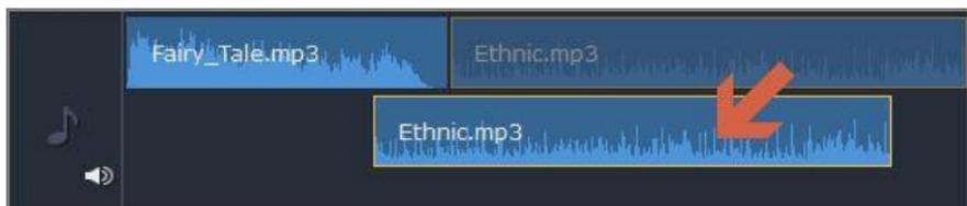
*Das Ende des ersten Audioclips wird mit dem Anfang des zweiten Clips wiedergegeben.*
