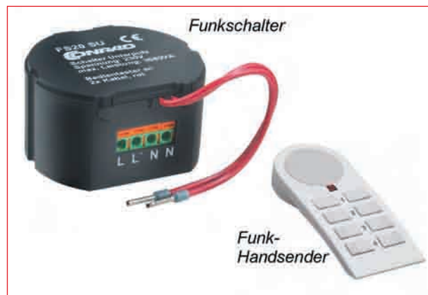
Abb. 7.14 – Ein Funkschalter mit einer max. Schaltleistung von 3.680 VA passt z. B. in eine Unterputz-Gerätedose, die für Lichtschalter oder Steckdosen verwendet wird. (Anbieter: Conrad Electronic)
