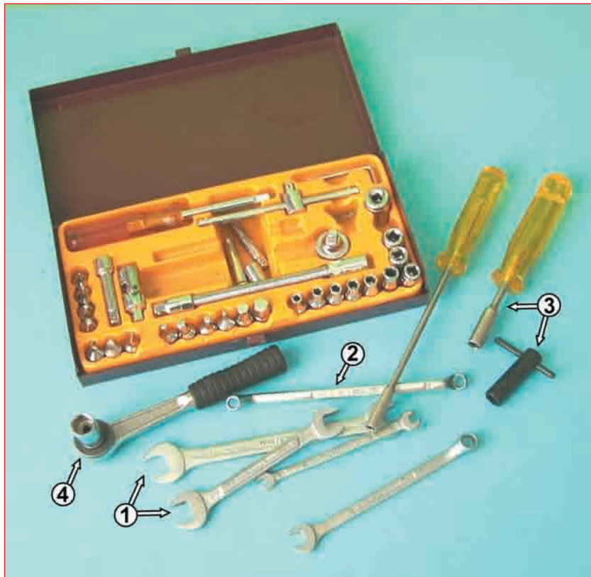
Abb. 2.27 – 1 Kleinere Mausschlüssel, 2 Ringschlüssel und 3 Steckschlüssel bzw. 4 Steckschlüsseleinsätze mit Ratsche sollten bei einem Heimwerker in den gängigen Größen vorhanden sein.
