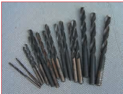
Abb. 2.19 – Metallbohrer sind ab einem Durchmesser von ca. 0,5 mm bis zu „faustdicken“ Durchmessern in Abstufungen von 0,1 mm erhältlich.
