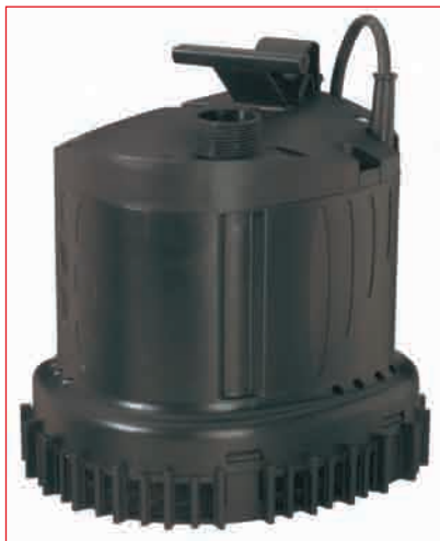
Abb. 10.3 – Die leistungsstarke Bachlauf-/Teichpumpe DW 5500 ist für eine Fördermenge von 5.500 l/h (= 5,5 m 3 Wasser pro Stunde) und eine max. Förderhöhe von 4 m und für eine 230-V~Versorgungsspannung ausgelegt. (Foto/Anbieter: Conrad Electronic)
