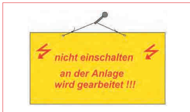
Abb. 7.4 – Besteht die Gefahr, dass ein Unbefugter Zugang zum Sicherungsautomaten hat, ist das Anbringen eines Warnschilds erforderlich.
