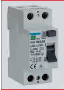
Abb. 7.9 – FI-Schutzschalter sind wahlweise als zweipolige Einphasen- oder als vierpolige Dreiphasen-Einbaugeräte erhältlich: Ausführungsbeispiel eines zweipoligen Einphasen-FI-Schutzschalters. (Foto/Anbieter: Conrad Electronic)
