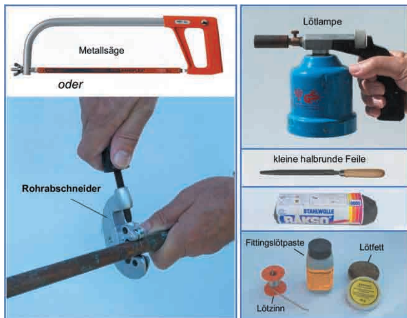
Abb. 6.4 – Für Wasserleitungsinstallationen mit Kupferrohrleitungen sind nur wenige Werkzeuge, Materialien und Hilfsmittel erforderlich.
