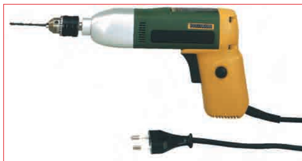
Abb. 2.16 – Für feinere und präzise Bohrungen eignet sich am besten eine kleine und leichte Bohrmaschine. (Anbieter: Conrad Electronic)
