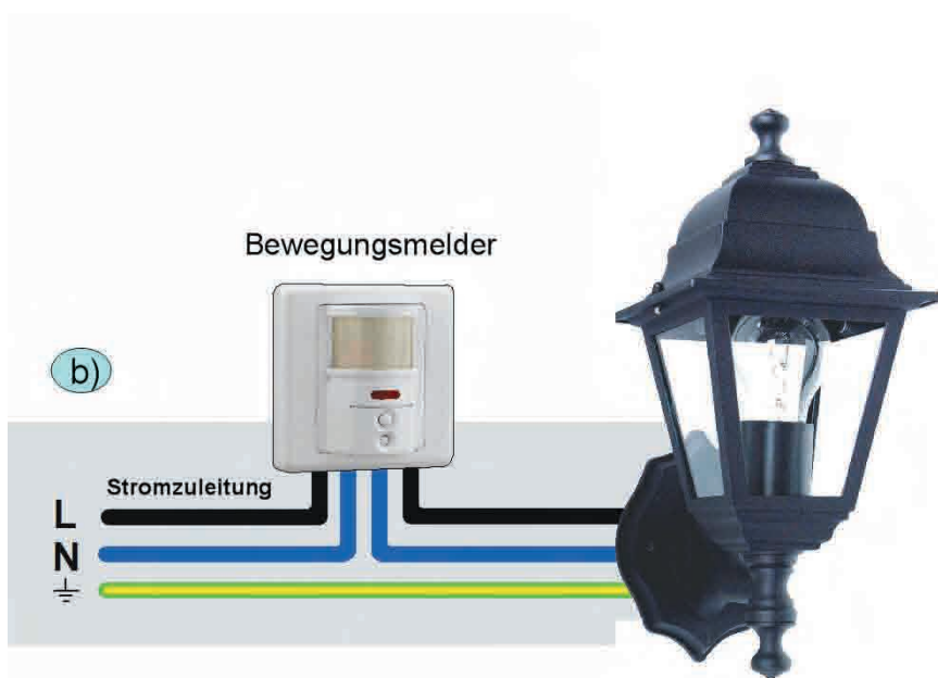
Abb. 8.10 – Leuchten mit Bewegungsmelder: a) mit in der Leuchte integriertem Bewegungsmelder; b) mit einem externen Bewegungsmelder (die Leuchte benötigt bei dieser Lösung entweder einen zusätzlichen Lichtschalter oder/und einen Dämmerungsschalter, damit sie nicht auch tagsüber aufleuchtet).
