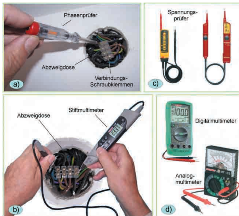
Abb. 7.7 – Wenn Sie eine Netzspannungsverbindungsdose (Abzweigdose) öffnen, die sich meist oben in der Wand befindet, sollten Sie erst mit einem Phasenprüfer (a) , einem Stiftmultimeter (b) , einem Spannungsprüfer (c) oder einem beliebigen Tischmultimeter (d) die Spannungsbelegung an den Verbindungsklemmen ermitteln und z. B. mit Permanent-Filzstiften farbig markieren.
