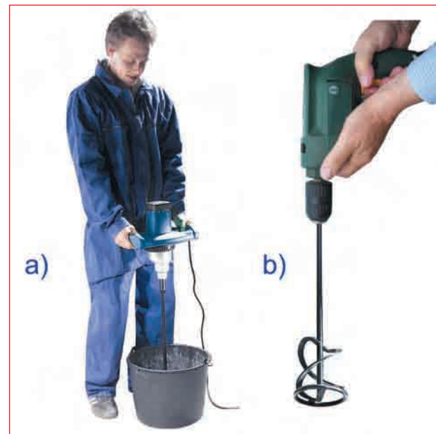
Abb. 8.8 – Mit einem kräftigeren Betonmischer (a) oder mit einer Mischspirale, die in eine Handbohrmaschine ab ca. 850 Watt eingesetzt wird (b), kann Beton in einem Bau-eimer in Portionen von etwa 20 bis 30 Litern gemischt werden.
