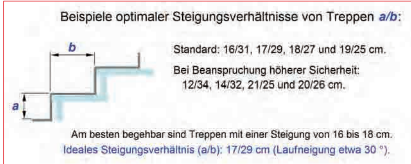
Abb. 5.4 – Richtmaße der Treppenstufen
