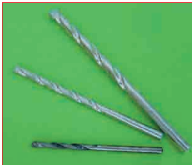
Abb. 2.20 – Steinbohrer sind meist nur in Durchmessern ab ca. 3 mm erhältlich und auf die Durchmesser der handelsüblichen Dübel abgestimmt.
