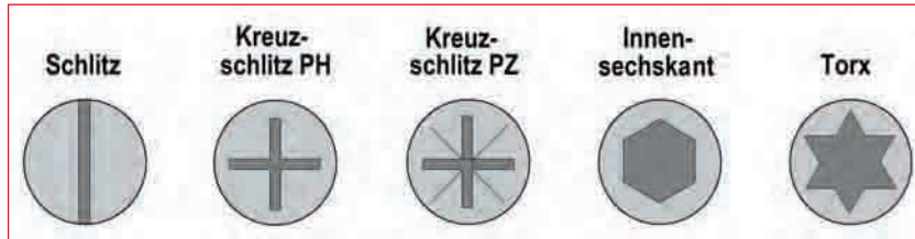
Abb. 2.26 – Übersicht der gängigsten Schraubenschlitze
