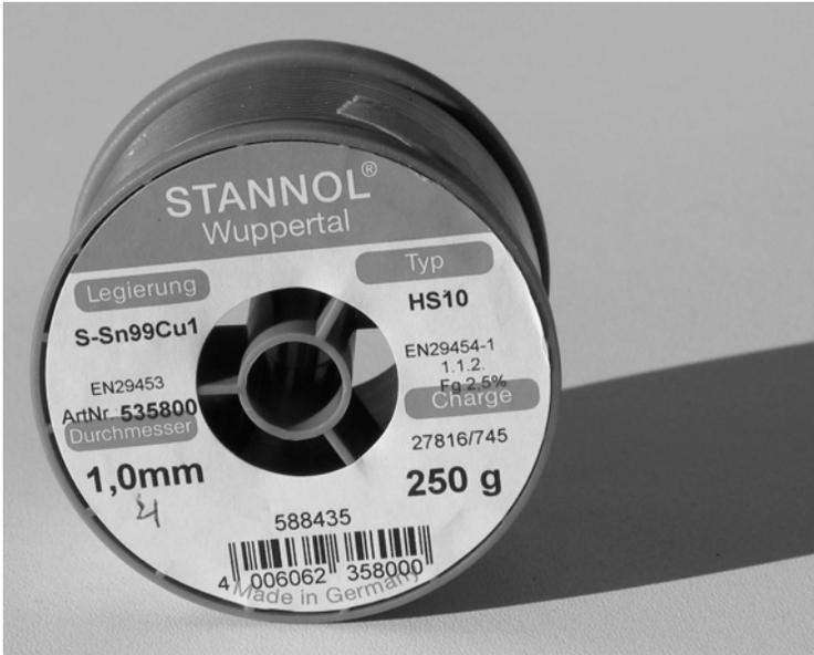
**Abb. 13.3** – Bleifreies Lot, das zu 99 Prozent aus Zinn und zu 1 Prozent aus Kupfer besteht.
