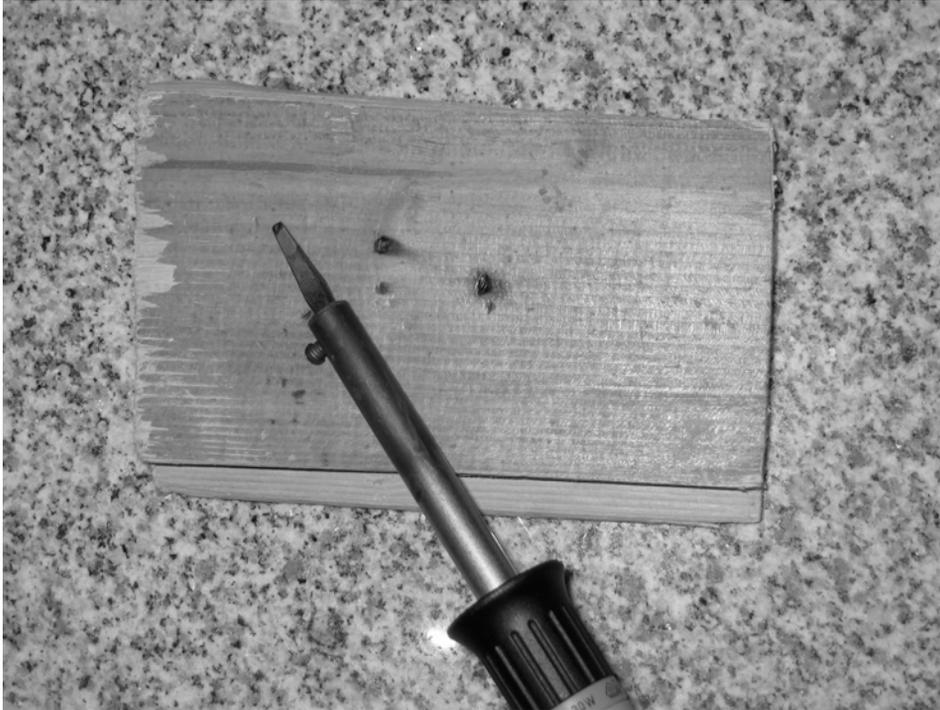
**Abb. 3.2** – Ein mittlerer 30-W-Lötkolben hinterlässt bereits nach 90 Sekunden hässliche Flecken auf einem Holzstück.
