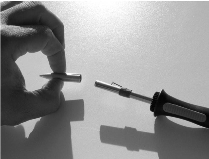
**Abb. 2.2** – Besonders komfortabel sind LötKolben mit Schnellwechselfspitze.
