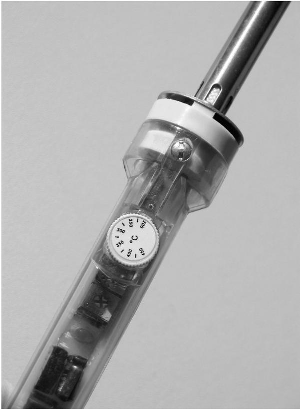
**Abb. 17.6** – Ein seltenes Exemplar: LötKolben mit einstellbarer Löttemperatur.
