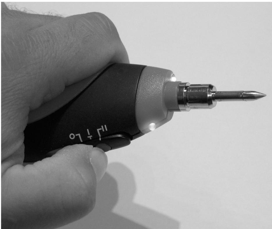
**Abb. 1.13** – Damit sich der Batterie-LötKolben aufheizt, ist der Taster am Schiebeschalter gedrückt zu halten. Zwei Leuchtdioden zeigen den Betriebsstatus an.
