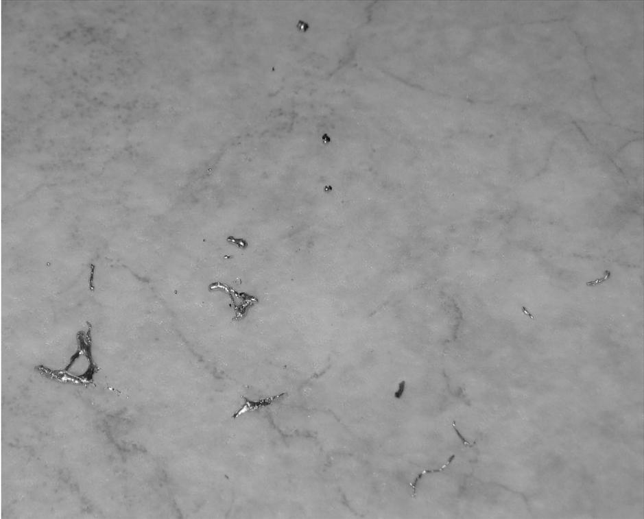
**Abb. 3.5** – Von der Lötspitze abgeschütteltes Lot verteilt sich unkontrolliert.
