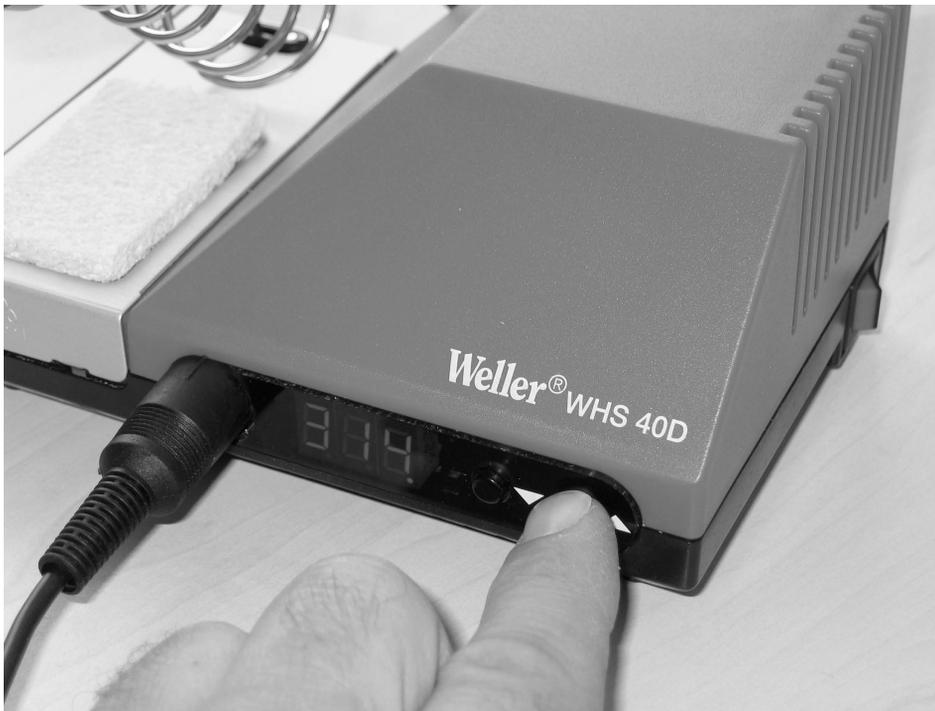
**Abb. 15.4** – Mit Tasten können Sie bei Geräten der gehobenen Mittelklasse die Löttemperatur gradgenau auswählen, programmieren und auf Tastendruck wieder abrufen.
