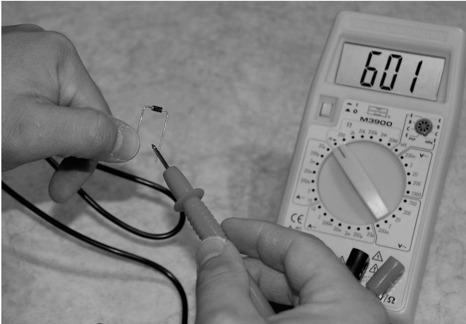
Abb. 6.13 – Das Multimeter zeigt den Innenwiderstand der Diode an. Damit sind Anode und Kathode sicher zu ermitteln.
