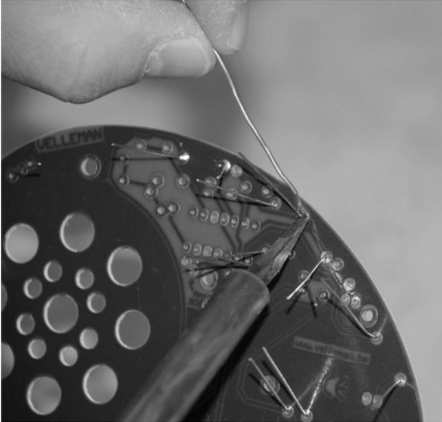
**Abb. 4.5** – Schritt 3: Die Lötspitze im Halbkreis rechts um das IC-Beinchen, das Lötzinn links herum führen.
