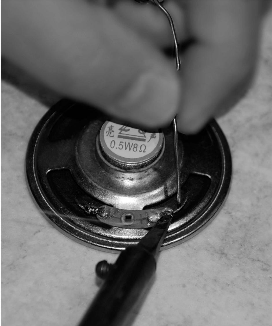
**Abb. 7.28** – Damit sich die Drähte besser anlöten lassen, sind beide Anschlusspunkte des Lautsprechers zu verzinnen.
