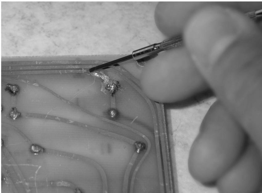
**Abb. 9.3** – Den Lack kann man auch mit einem kleinen Schraubenzieher entfernen.
