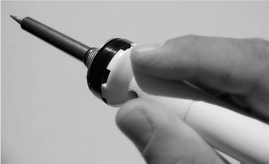
**Abb. 1.3** – Ein großzügiger Abrutschschutz beugt Verbrennungen vor.
