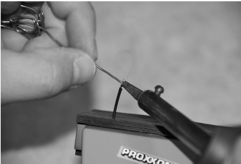
Abb. 16.1 – Schritt 1: Drahtende verzinnen.
