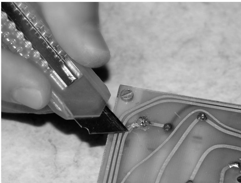
**Abb. 9.2** – Schritt 1: Nachdem Sie den losen Teil der Leiterbahn herausgeschnitten haben, schaben Sie den Isolierlack auf einem Stück der noch intakten Leiterbahn vorsichtig ab.
