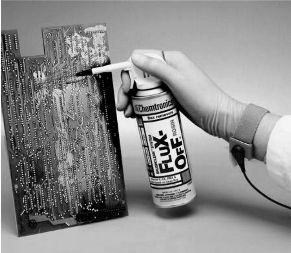
**Abb. 2.20** – Mit einem Flussmittelspray lassen sich Lötrückstände bequem entfernen. Wischen Sie mit einem Tuch nach. (Foto: Chemtronics)
