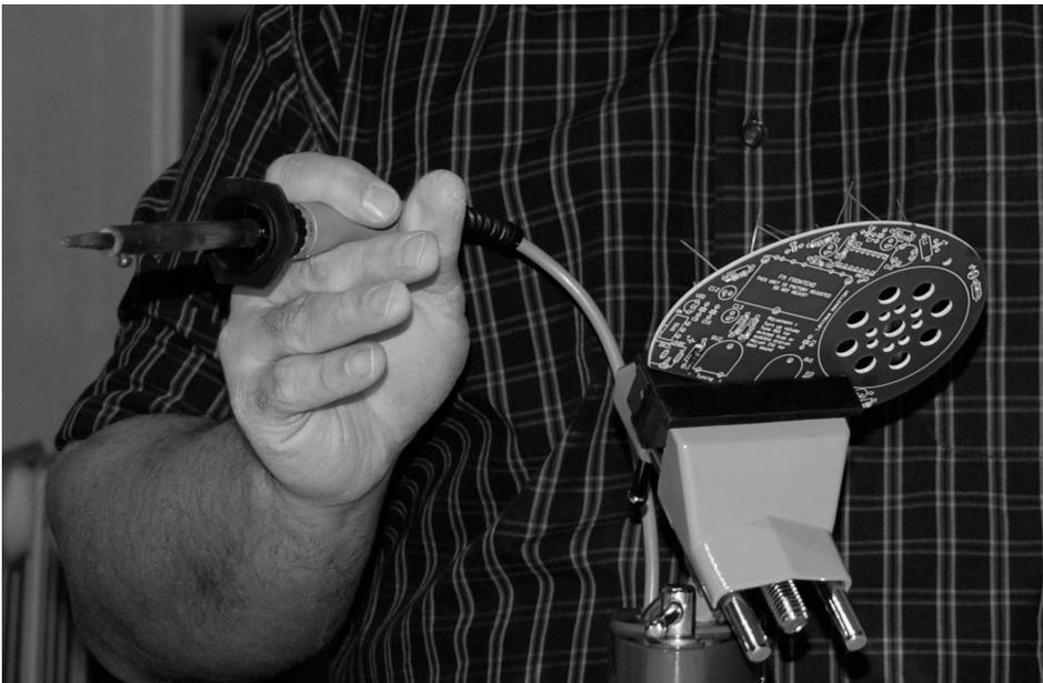
**Abb. 4.6** – Schritt 4: Nachdem Sie den Lötdraht von der Lötstelle entfernt haben, die Lötspitze schnell wegziehen – fertig.
