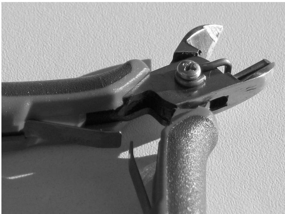
**Abb. 2.6** – Elektronikerseitenschneider mit Drahtklammer.
