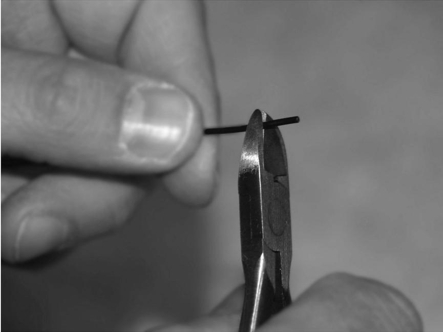
Abb. 7.24 – Um die Stromversorgungskabel anzulöten, die Drahtenden abisolieren und ...
