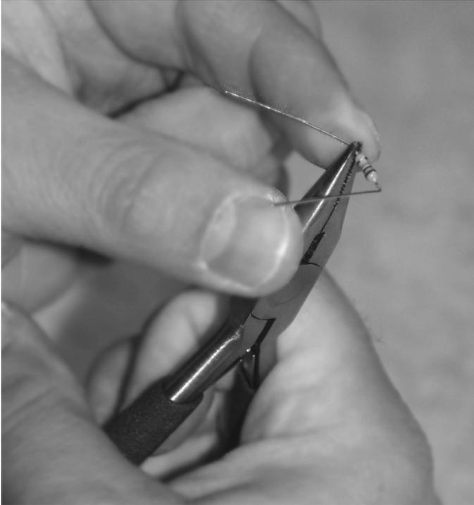
**Abb. 7.5** – Beide Enden des Widerstands im ermittelten Abstand mit einer Flachzange vorsichtig rechtwinkelig zurechtbiegen.
