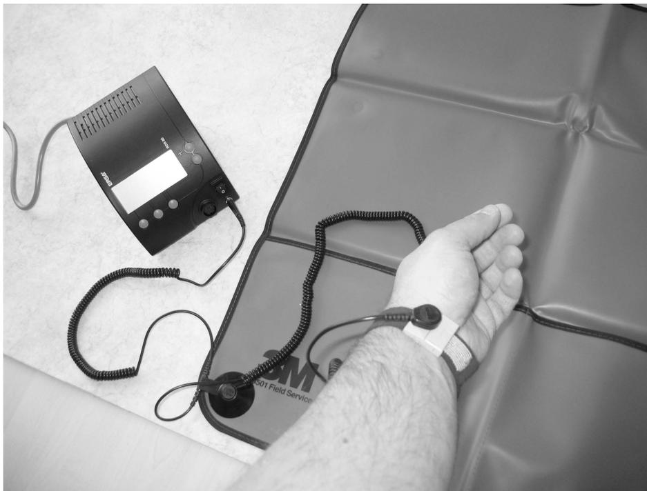
**Abb. 7.17** – Das Armgelenk ist über eine Manschette mit der Potenzialausgleichsbuchse verbunden und liegt so am für das Bauteil ungefährlichen Potenzial.
