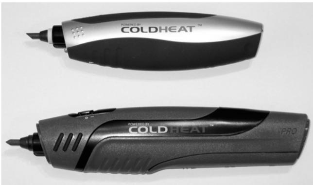
**Abb. 17.1 –** Zwei Kaltlötgeräte. Man spricht auch von Coldheat-Lötern, die äußerlich üblichen BatterieLötKolben gleichen.
