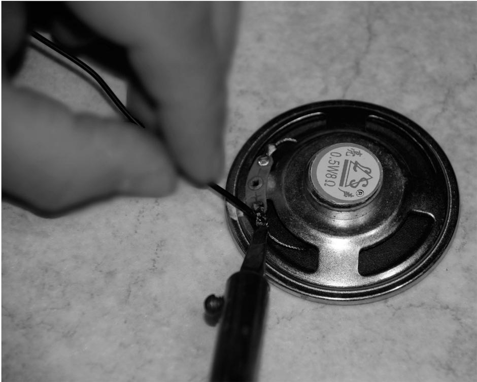
Abb. 7.29 – Anlöten der Kabel an den Lautsprecher.
