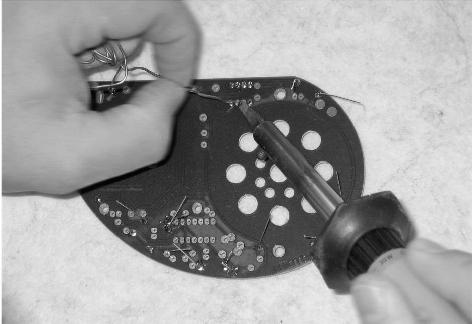
Abb. 7.13 – Ein IC lässt sich noch mit einem UniversallötKolben löten.
