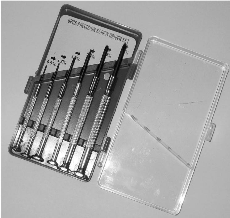
Abb. 2.10 – Feinmechaniker-Schraubendreher im Set.
