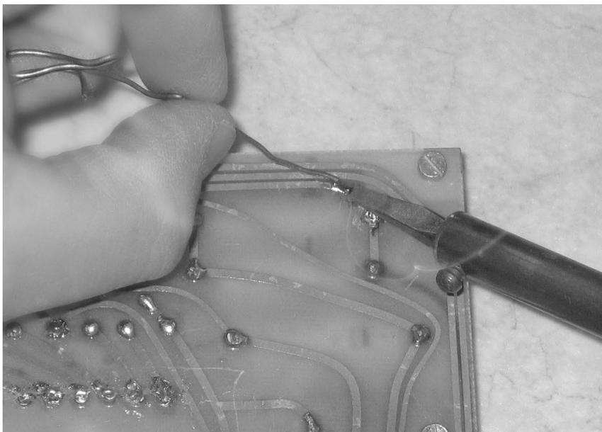
**Abb. 9.4** – Schritt 2: Auf die blanken Stellen der Leiterbahn muss etwas Lot aufgetragen werden.
