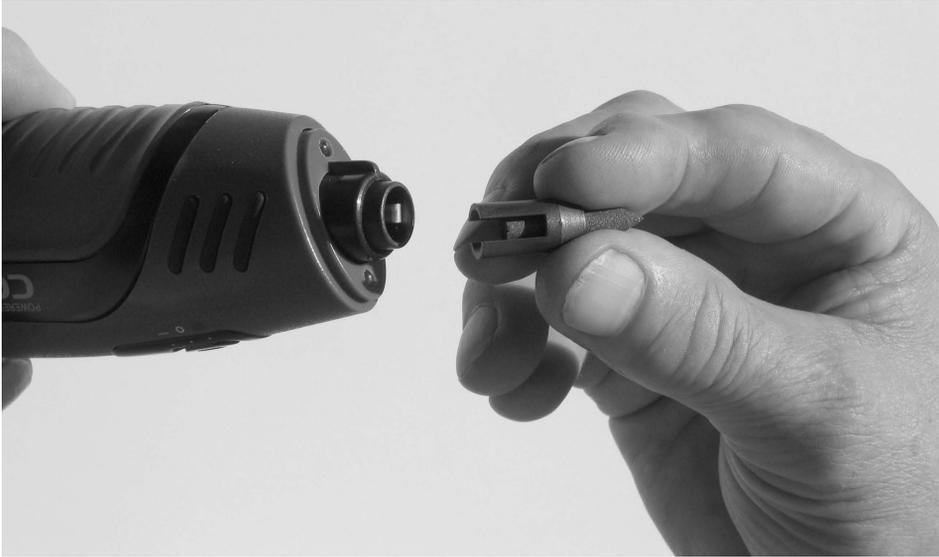
Abb. 17.2 – Die Lötspitze aus Kohlefaser ist aufgesteckt und lässt sich leicht auswechseln.
