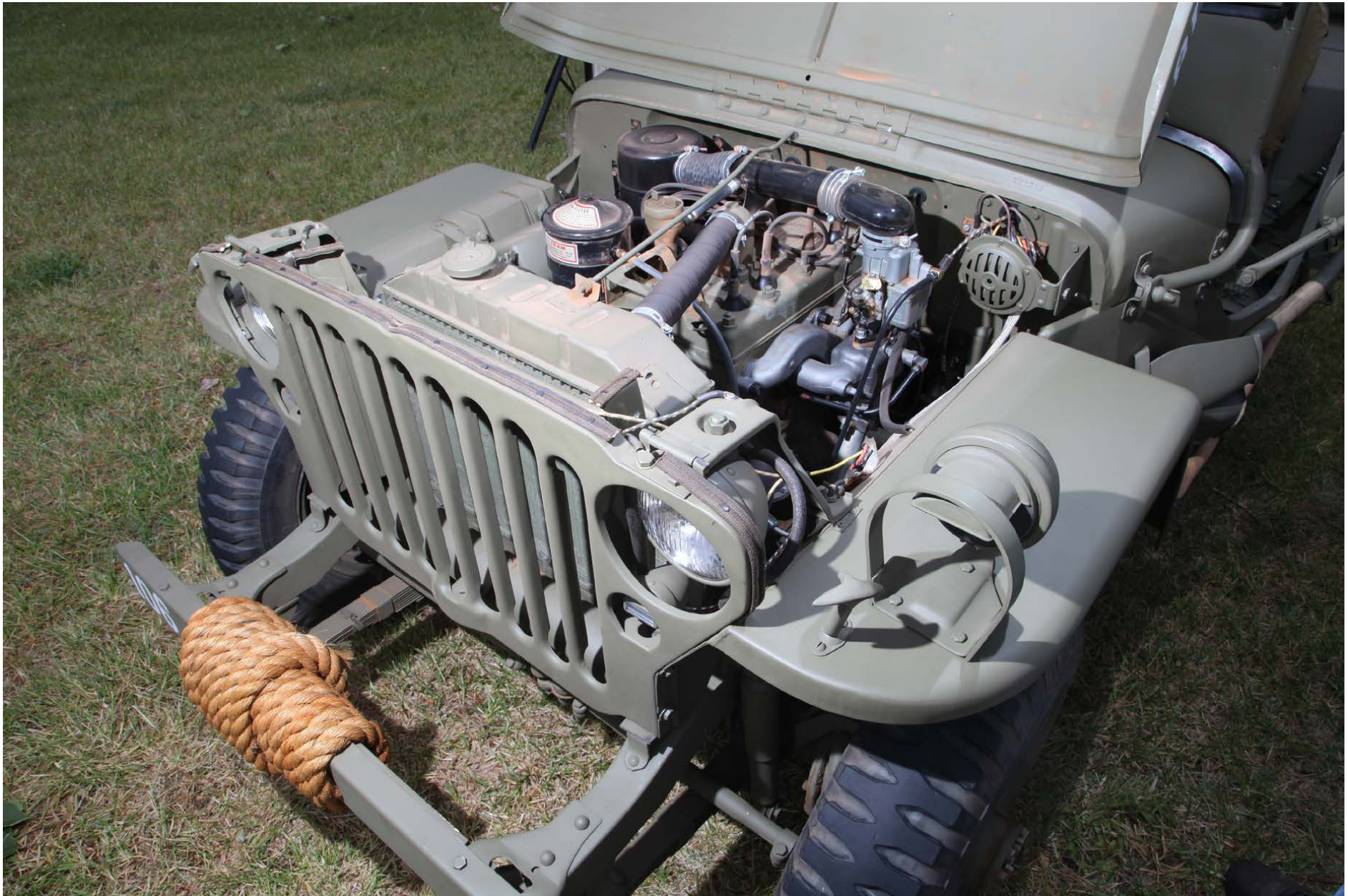
Der Willys MB wurde von einem robusten 2,2-Liter-Reihenmotor angetrieben. The Willys MB was driven by a robust 2.2 liter in-line engine.
