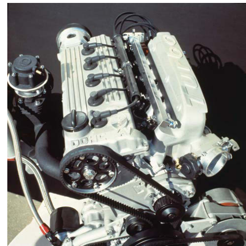
Audi setzte 1980 im Quattro auf einen Reihen-Fünfzylinder-Motor mit Turbolader. For the Quattro, Audi relied on a 5-cylinder in-line engine with turbo charger.
