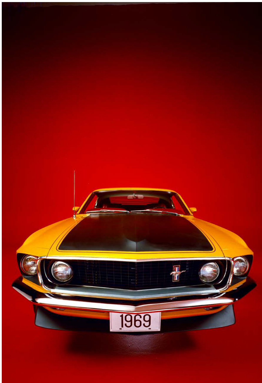
Ford Mustang Boss 302 aus dem Jahr 1969. Sein 5-Liter-V8-Motor leistete 216 kW (290 PS). Ford Mustang Boss 302 of 1969. The 5-liter V8 engine provided 216 kW (290 hp).
