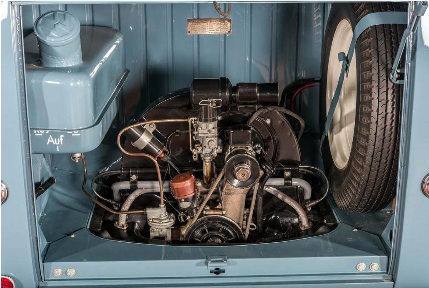
Im VW Bus T1 arbeitete eine modifizierte Variante des Käfer-Boxermotors. The VW Bus T1 was driven by a modified version of the Beetle flat engine.
