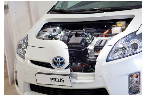
Schnittmodell des Toyota Prius III Plug-in-Hybrid aus dem Jahr 2010.
