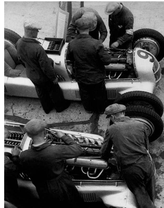
Wartungsarbeiten: Zündkerzenwechsel an zwei Mercedes-Benz W25 vor dem Großen Preis von Deutschland 1934.
