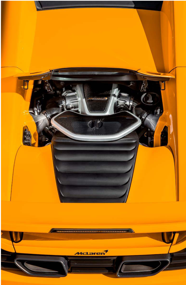
Das Triebwerk mit der internen Bezeichnung „M838T“ kam im McLaren 12C als Mittelmotor zum Einsatz. The engine with the internal designation “M838T” was mounted as a midship engine in the McLaren 12C.
