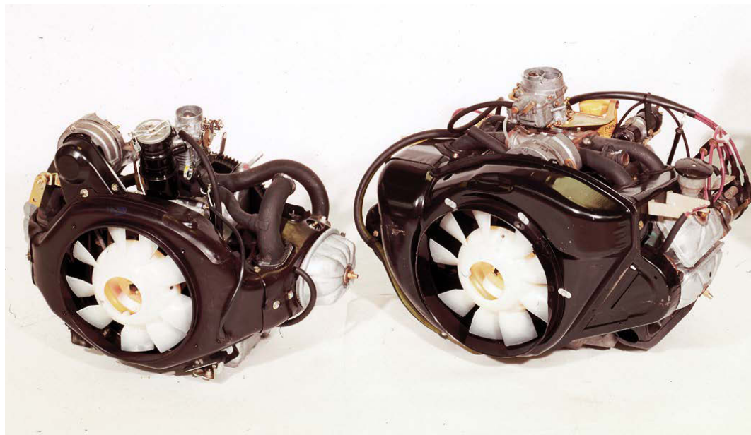
Die Gebläse-gekühlten Boxermotoren der „Ente“ waren simple, aber durchaus robuste Gesellen. The fan-cooled flat engines of the “duckling” were simple but robust fellows.
