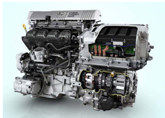
An den 1,8-Liter-Benzinmotor mit 73 kW (99 PS) ist ein Elektromotor gekoppelt.
