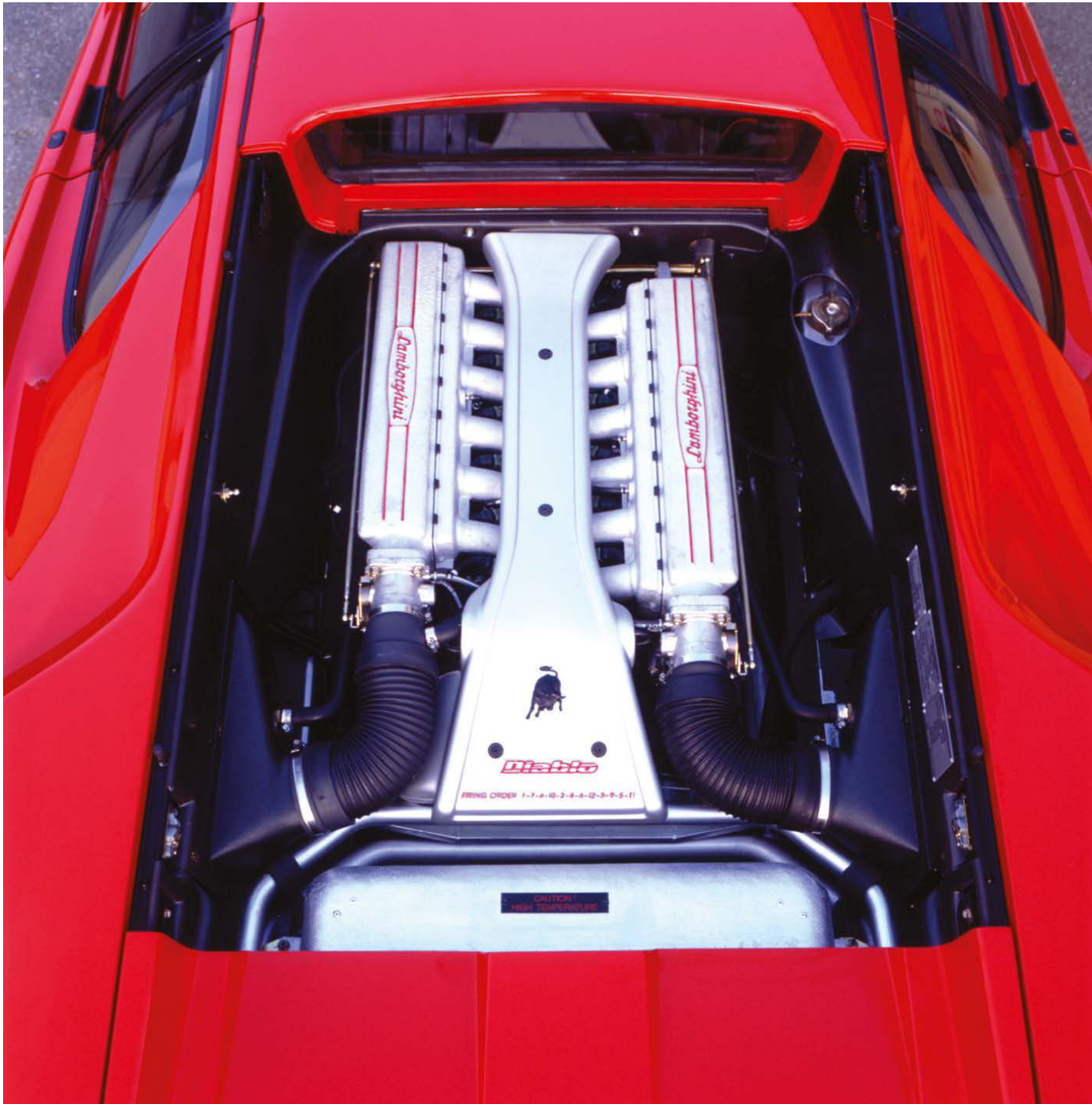
Der 5,7-Liter-Motor des 1993er Diablo VT brachte es auf 367 kW. The 5.7 liter engine of the 1993 Diablo VT provided 367 kW.
