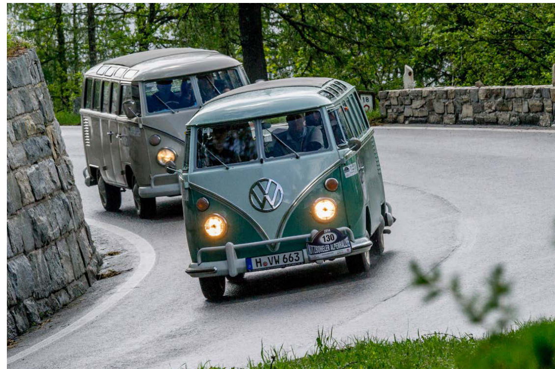
Das Kennzeichen des VW Busses der ersten Generation war die geteilte Windschutzscheibe. The split windscreen was a distinguishing mark of the first generation of the VW Bus.
