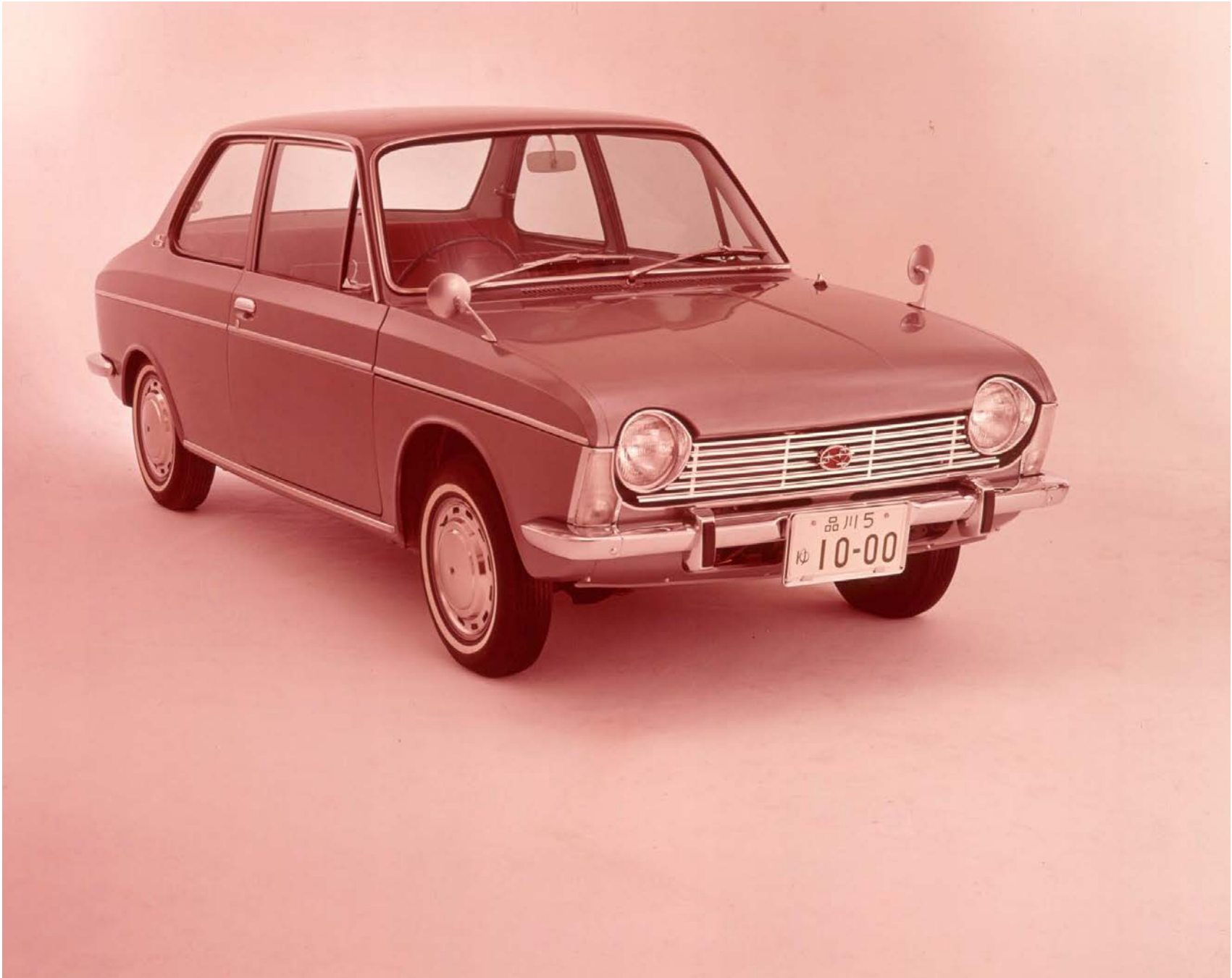
Der Subaru 1000 war der erste mit einem Boxermotor ausgestattete Wagen des japanischen Herstellers. The Subaru 1000 was the first car of the Japanese manufacturer that sported a flat engine.
