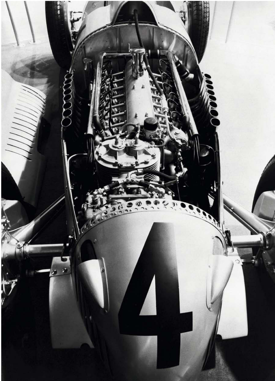
Der 6,0-Liter-V16-Zylinder aus dem Grand-Prix-Boliden wurde auch im Rekordwagen benutzt. The 6.0-liter V16 engine of the Grand Prix racing car was also used in the record car.
