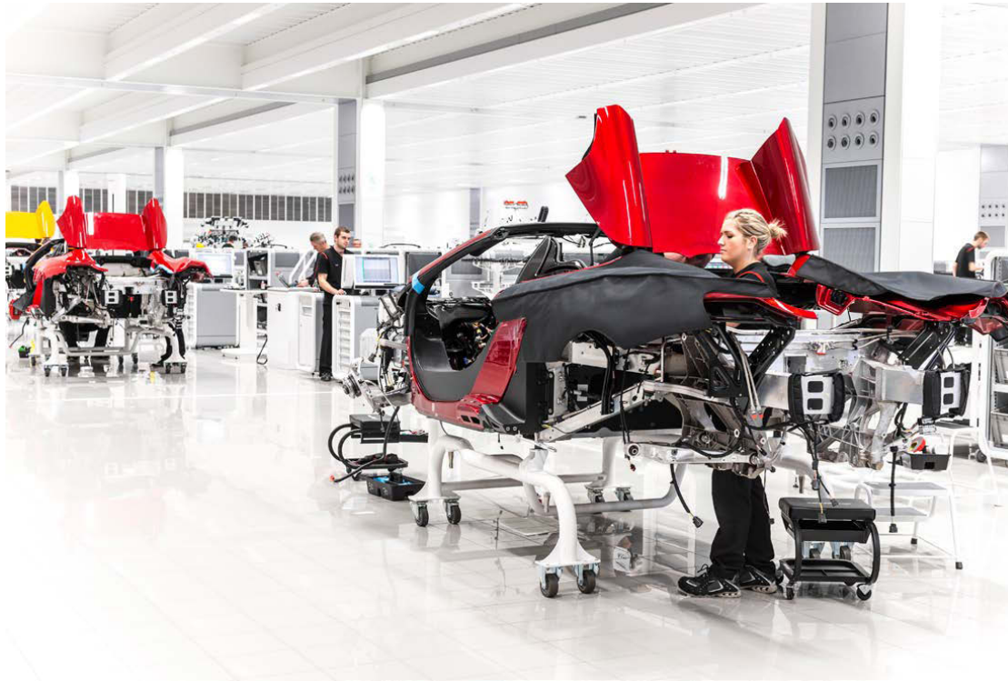
Einbau eines 3,8-Liter-V8-Motors vom Typ M838T in einen McLaren MP-4 12C Spider.
