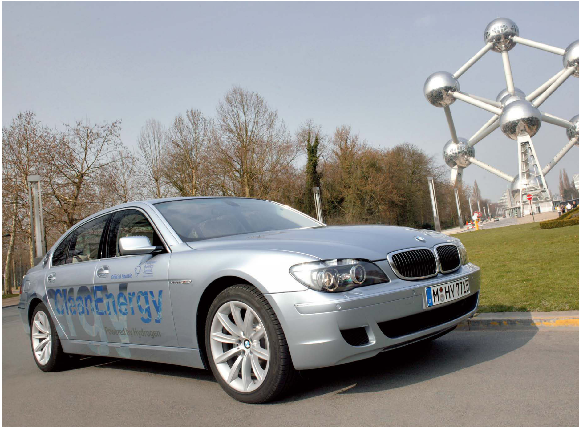
Der BMW Hydrogen 7 aus dem Jahr 2006 wurde von einem Wasserstoff-Verbrennungsmotor angetrieben. The BMW Hydrogen 7 built in 2006 was driven by a hydrogen combustion engine.
