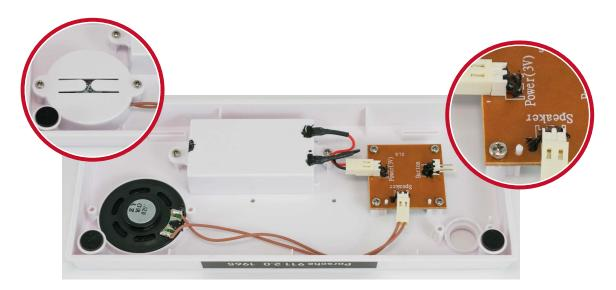
Nehmen Sie noch einmal vorsichtig die Hintergrundtafeln von der Basis-Oberseite, denn Sie müssen wieder Arbeiten an der Unterseite durchführen. Der heutige Tag bringt Ihnen einen Lautsprecher. Befestigen Sie ihn entsprechend der Abbildung mithilfe von vier Schrauben an der passenden Stelle. Die Schrauben nicht zu fest anziehen, um eine Beschädigung der Drähte zu vermeiden.
