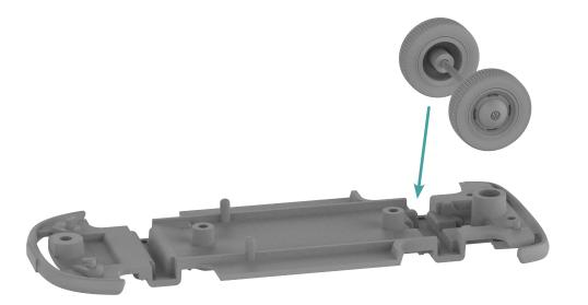
Heute folgt das nächste Bauteil für das Modellauto. Es ist die zweite Achse. Legen Sie die Achse in die zweite der beiden Vertiefungen auf dem Chassis.
