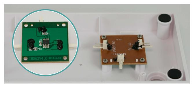
Tag Nummer 6 bringt Ihnen ein Soundmodul, das Ihr Modellauto später soundtechnisch zum Leben erwecken wird. Befestigen Sie das Modul mithilfe von vier Schrauben auf der Unterseite der Basis. Zwei kleine Löcher korrespondieren mit zwei kleinen Stiften an der Basis. Beachten Sie auch genau die Abbildung!
