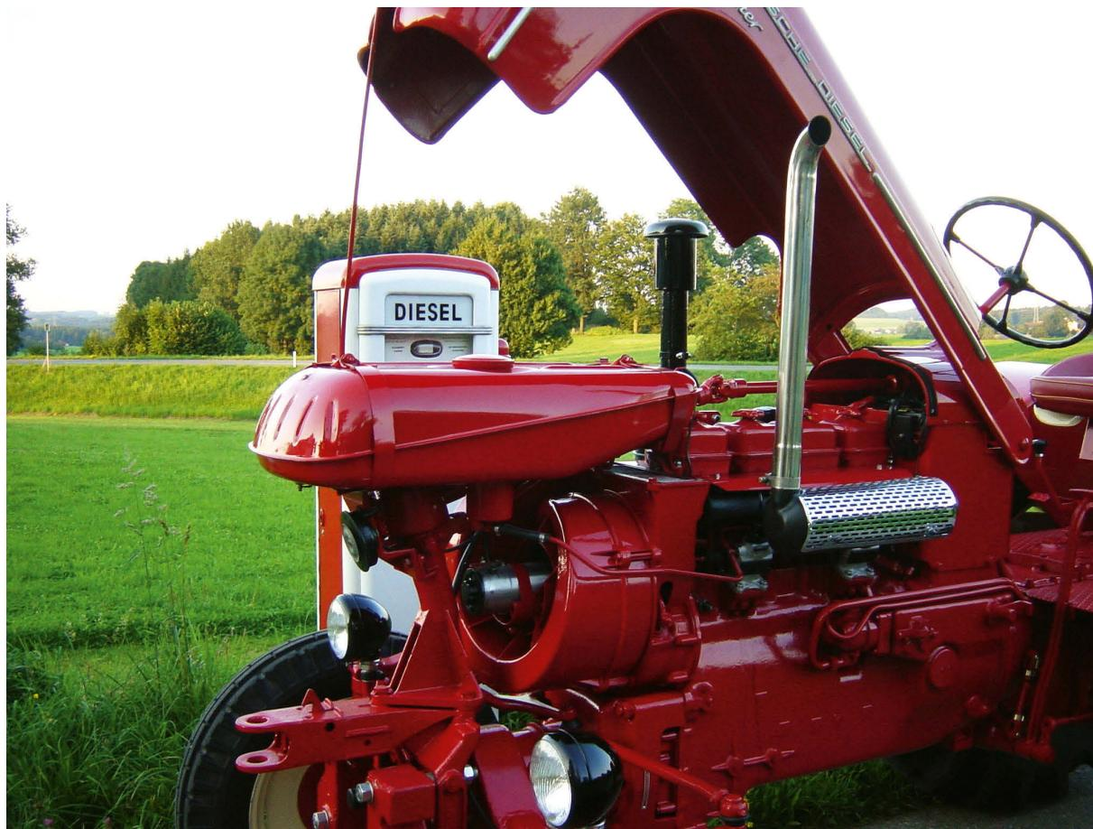
Unter der Haube: ein Vierzylinder-4-TaktReihen-Wirbelkammermotor
