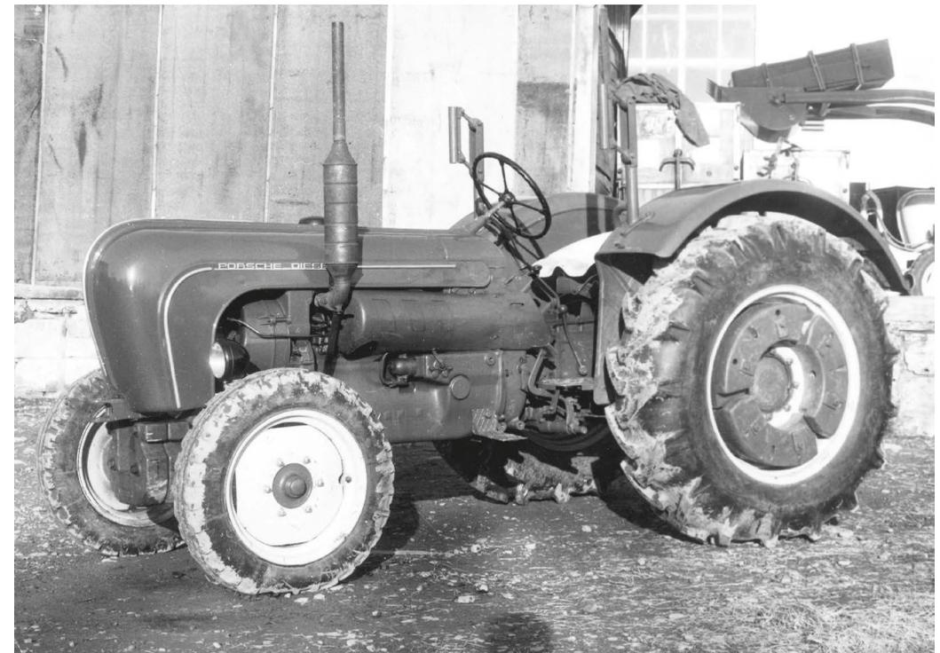
Schlepper der Baureihe „Super“ waren mit einem Dreizylinder-Motor ausgestattet
