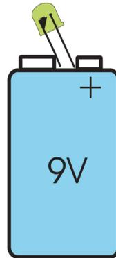
Halten Sie die beiden Anschlussdrähte direkt an die Pole einer 9-V-Batterie. Sie leuchtet hell auf. Wenn Sie die LED falsch herum anschließen, passiert weiter nichts. Es fließt dann kein Strom, die LED leuchtet nicht.
