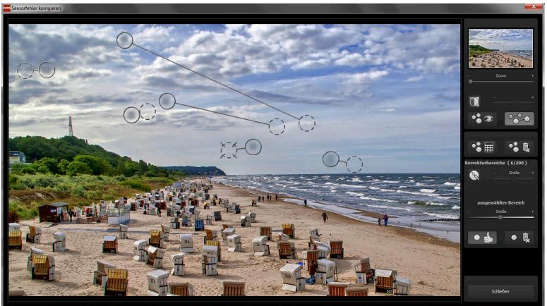
In der Sensorfleckenkorrektur werden die Flecken markiert und eine passende Quelle im Bild ermittelt, die die fleckigen Bereiche ersetzen kann.
